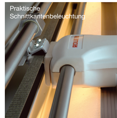
Selbstschärfender und wartungsfreier Messerkopf
