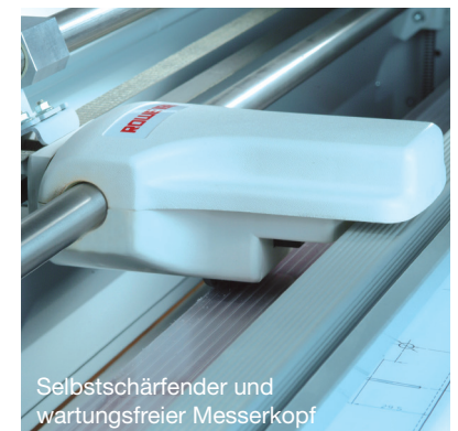
Effizientes Schneiden durch Kurztastbetätigung
